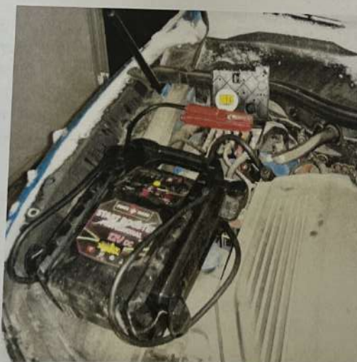
Фото 7. Разряженная АКБ исследуемого автомобиля.
