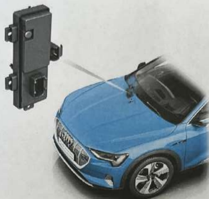
Ил. 7. Блок управления системы регулирования АКБ.
